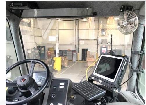
*L'intérieur d'un tracteur de manœuvre équipé d'un ordinateur intégré.*
