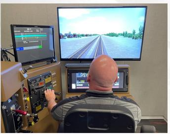
Le simulateur de mécanicien de locomotive reproduit toutes les commandes d'une vraie locomotive : leviers de robinets de frein, manipulateur de traction et tous les écrans servant à surveiller l'état du train et la pression d'air. Des caractéristiques de sécurité avancées comme la CIT et des écrans sur les efforts d'étirement et de compression du train aident les apprentis à maîtriser la conduite sécuritaire des trains.
