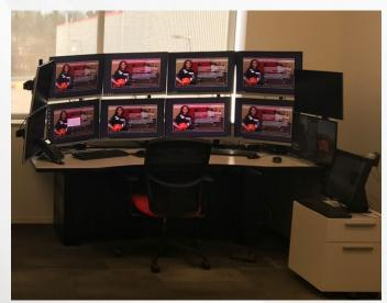
Le simulateur Precision Dispatch System (PDS) de contrôle de la circulation ferroviaire reproduit les fonctionnalités du PDS pour permettre aux contrôleurs de la circulation ferroviaire (CCF) de s'exercer à diverses tâches, notamment la manœuvre des signaux, la protection des mouvements et les interventions en cas d'urgence.
