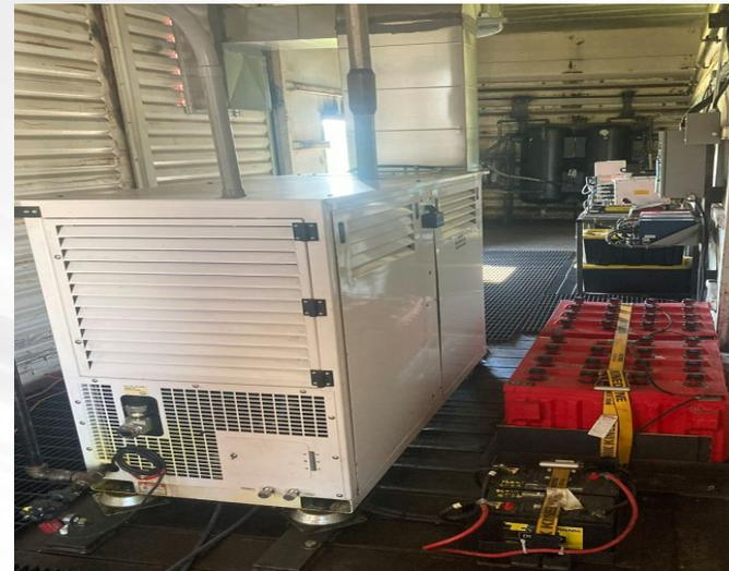
**À l'intérieur de la boîte :** Moteur, compresseur d'air, batterie, frein à air et composants électroniques.
