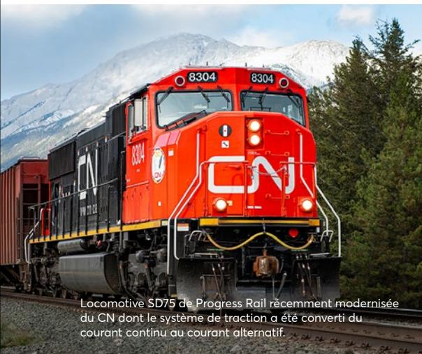
Locomotive SD75 de Progress Rail récemment modernisée du CN dont le système de traction a été converti du courant continu au courant alternatif.
