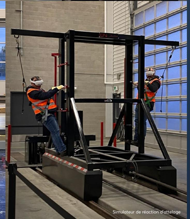
Simulateur de réaction d'attelage
