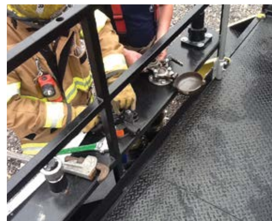
Formation de pompiers pour le remplacement d'un disque de rupture de wagon-citerne sur la remorque de formation des marchandises dangereuses du CN.
