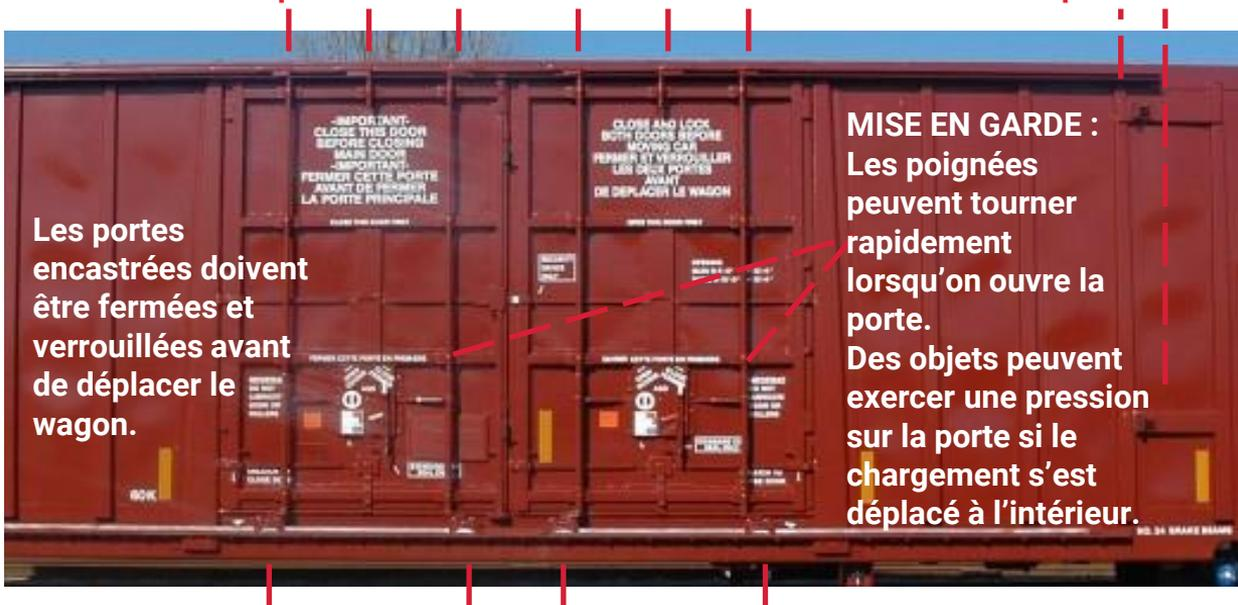
Les portes encastrées doivent être fermées et verrouillées avant de déplacer le wagon.
