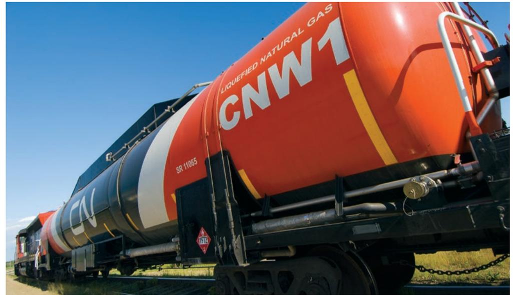
➤ **ESSAIS D'UTILISATION DE GAZ NATUREL LIQUÉFIÉ (GNL) DANS LES LOCOMOTIVES** : Un programme d'essais a fourni des données précieuses sur l'utilisation du GNL dans nos locomotives. Comme le GNL a une teneur en carbone moindre que celle du diesel, les locomotives au GNL produiraient moins d'émissions de dioxyde de carbone. Les essais se sont poursuivis en 2013, et nous comptons aussi étendre l'expérience à l'alimentation des locomotives de grande puissance.
