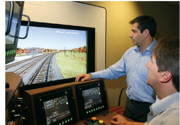
**➤ SIMULATEURS DE CONDUITE – UN OUTIL PRÉCIEUX POUR LA FORMATION DES MÉCANICIENS DE LOCOMOTIVE :** Pour former les mécaniciens de locomotive, le CN dispose de huit simulateurs de conduite informatisés permettant de simuler la conduite d'un train et les activités de transport ferroviaire. Les simulateurs de conduite feront partie du matériel le plus important dont seront dotés les centres de formation ultramodernes du CN.
