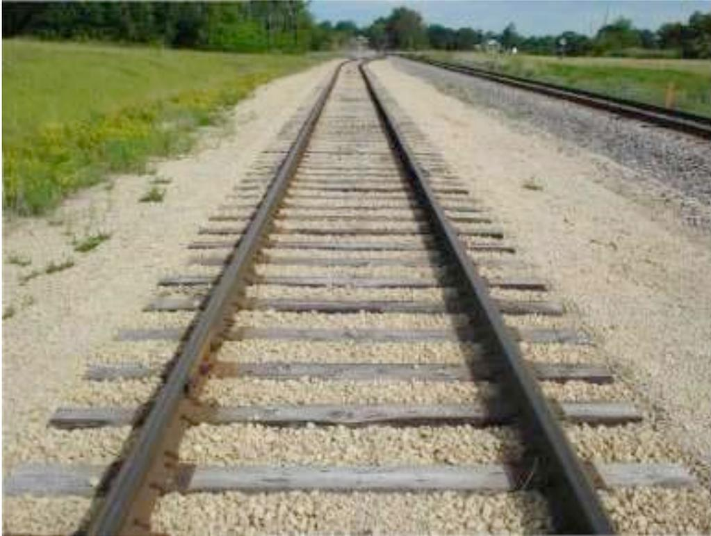
(Figure 11 : Ballast propre)
