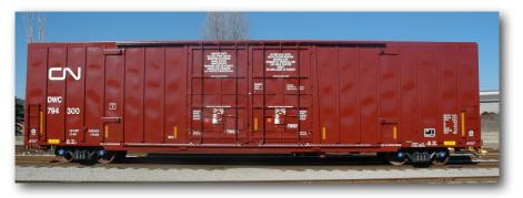
PLUG DOORS MUST BE CLOSED AND LOCKED BEFORE MOVING CAR.
