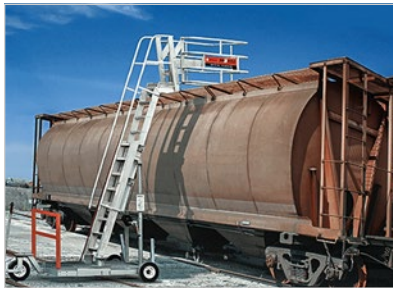
Figure 1. Protection contre les chutes – Dispositif échelle-plateforme
